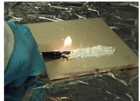
**Abbildung 1: Experimentelle Bestimmung der Brennzahl**
